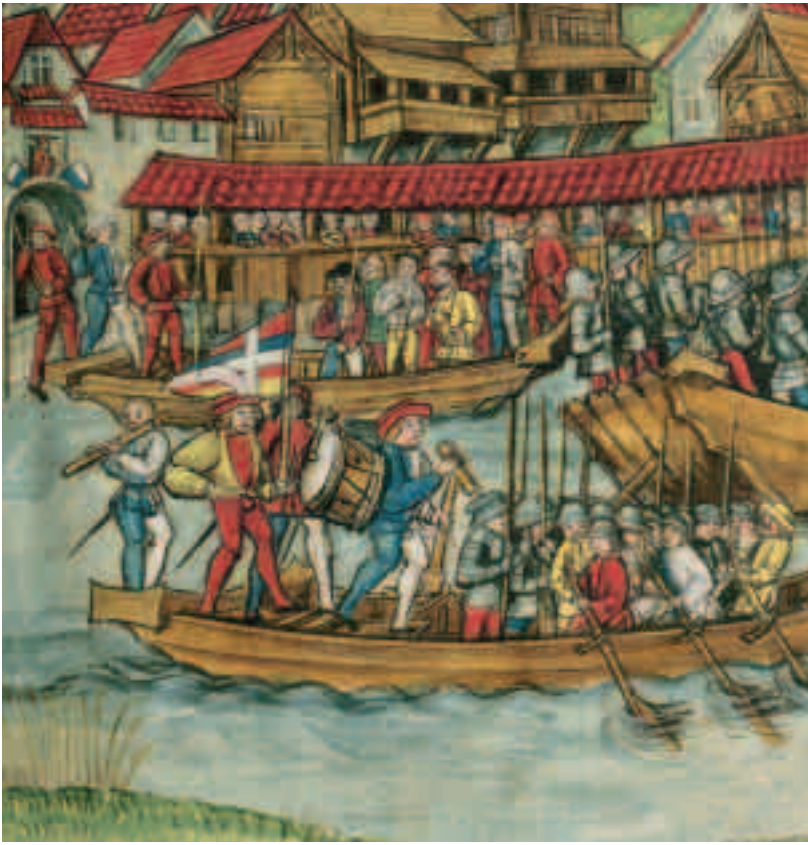
Abb. 6 Traditionelle Lastschiffe, mit Jochbalken am Heck, seitlich angebrachten und mit Weidenruten befestigten Fahrrudern für die Fortbewegung und einem durch das Streichloch gesteckten Streichruder am Heck für die Steuerung. Ausschnitt aus der Luzerner Chronik von Diebold Schilling, um 1513, fol. 278r (Eigentum Korporation Luzern).
