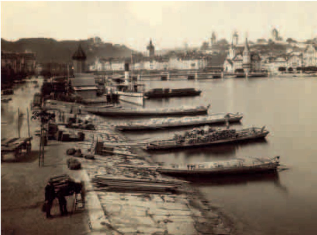
Abb. 26 Lastensegler vom jüngeren Typus des Obermatt-Nauens an der linksufrigen Liegestelle in Luzern, zweite Hälfte 19. Jh. (nach 1870). Die Masten werden nur zum Segeln vor dem Wind gesetzt. Unterscheidung vom älteren Typ durch fehlende Jochbalken sowie Heckform mit Seitenruder und Pinne. Originalfoto ZHB Luzern, LSa. 8.10.5(1).
